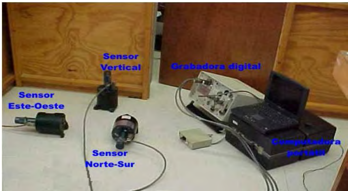
Figura 7. Configuración típica del equipo sismológico empleado en el registro de microtremores, para la medición de los periodos dominantes del suelo, en Mexicali, B.C.
