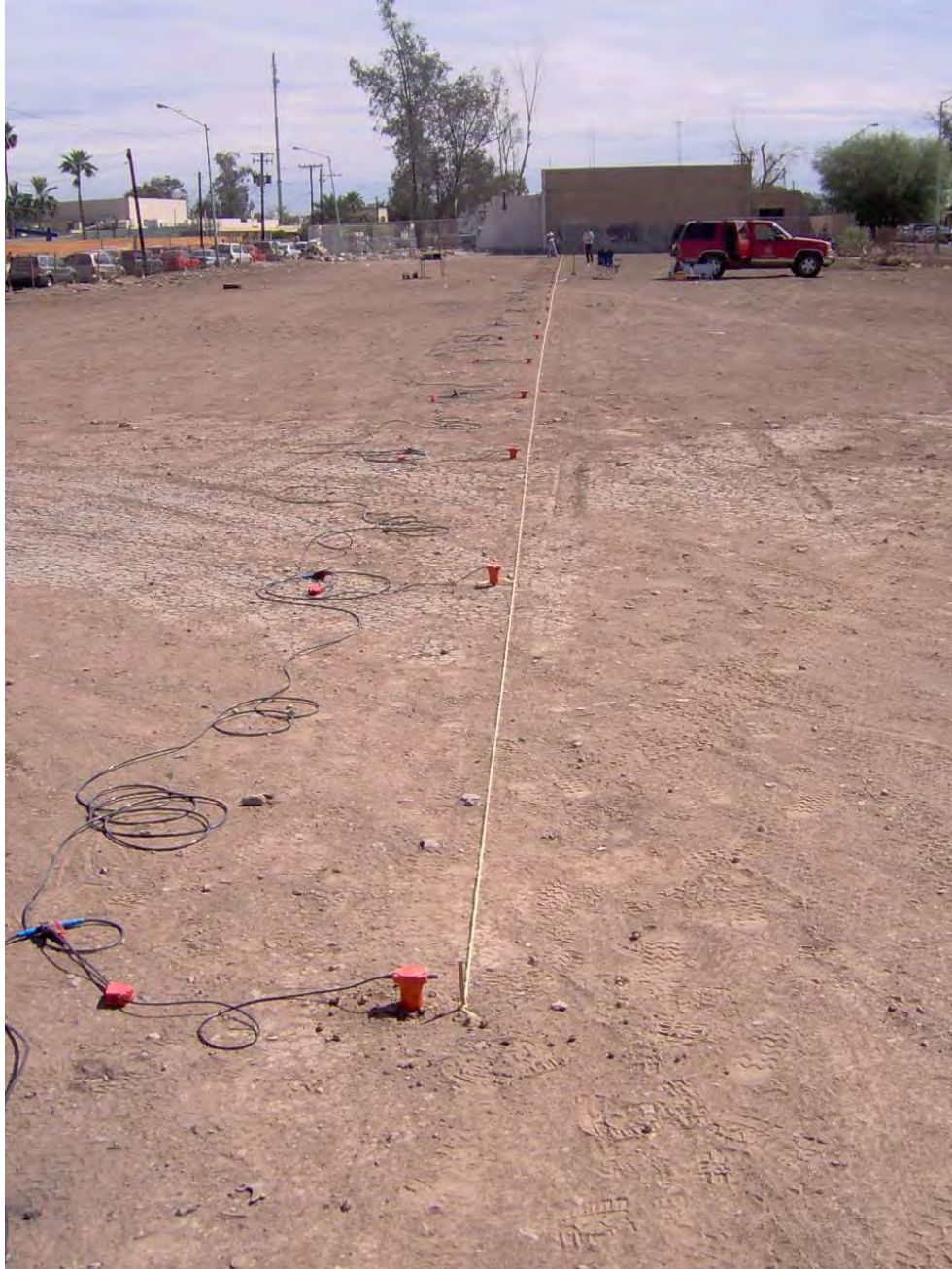
Figura 11. Ilustración de la configuración del perfil lineal, con 24 sensores verticales, para el registro de microtremores. El sitio mostrado es PO3, en Mexicali, B. C.
